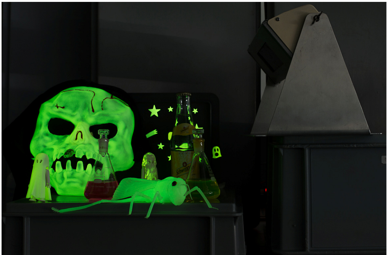
Die UV-Lampe ist ausgeschaltet: Nun leuchten nur noch die phosphoreszierenden Gegenstände
