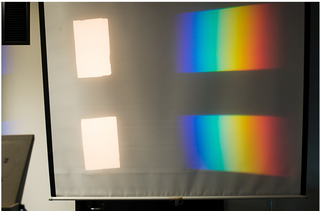
Die zwei Öffnungen ergeben zwei Spektren auf der Leinwand
