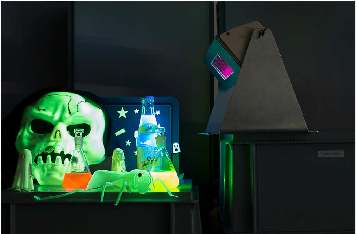
Die UV-Lampe ist eingeschaltet: Sowohl die fluoreszierenden als auch die phosphoreszierenden Gegenstände leuchten
